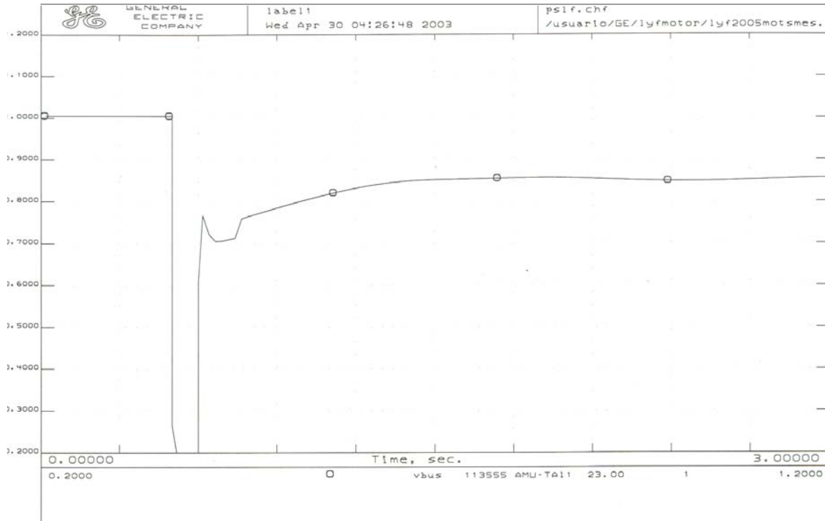
Figura No. 6.24. Efecto los SMES conectados en AMU-23 y ATU-23 en el perfil de voltaje del nodo AMU-Tal1 ante la contingencia AMU-AMY
